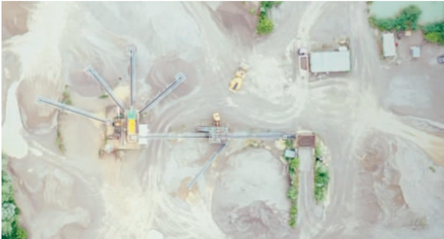
Die Sortier- und Waschanlage für Kies und Sand im Kieswerk Tullius im Altdorfer Wald.
