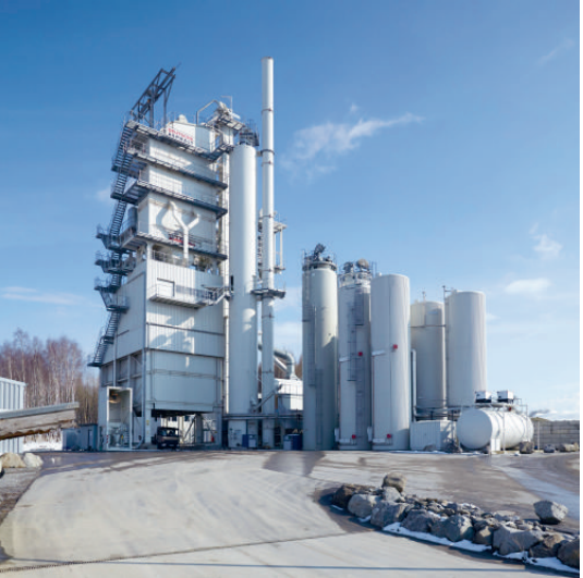
Asphaltmischanlage in Grenis. Sie wird mit Braunkohlestaub betrieben.
