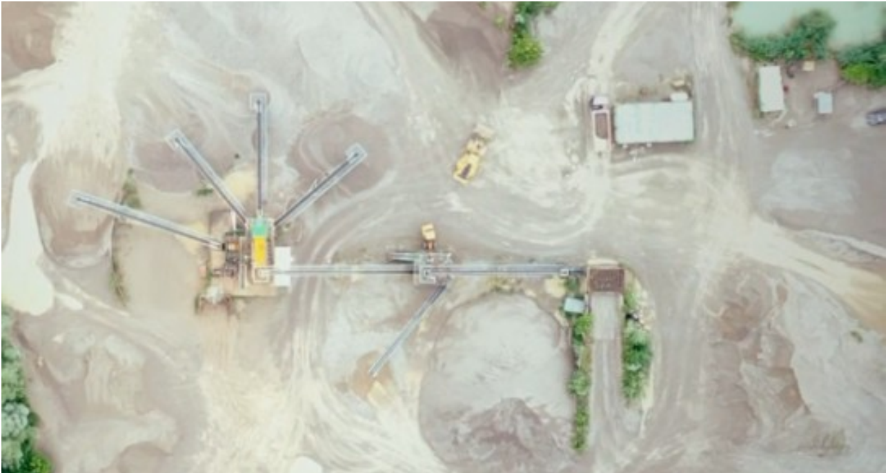
Die Sortier- und Waschanlage für Kies und Sand im Kieswerk Tullius im Altdorfer Wald.
